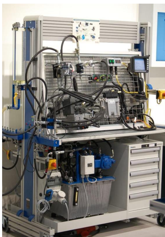
Rys. 5. Stanowisko dydaktyczne ze zmontowanym układem z zakresu hydrauliki mobilnej (źródło: Bosch Rexroth).
