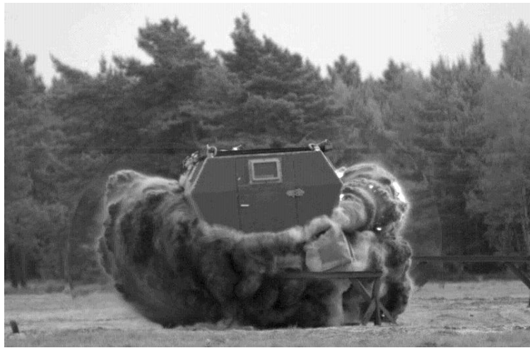
Fot. Próby na poligonie: manekin we wnętrzu pojazdu, wybuch ładunków.
