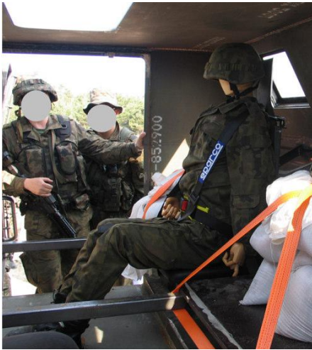
Fot. Próby na poligonie: manekin we wnętrzu pojazdu, wybuch ładunków.
